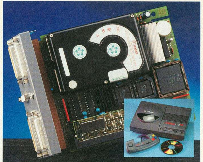
Das SX 32: Ein erstaunliches Modul für das CD 32 , das es zu einen vollwertigen Amiga 1200 heranwachsen läßt
